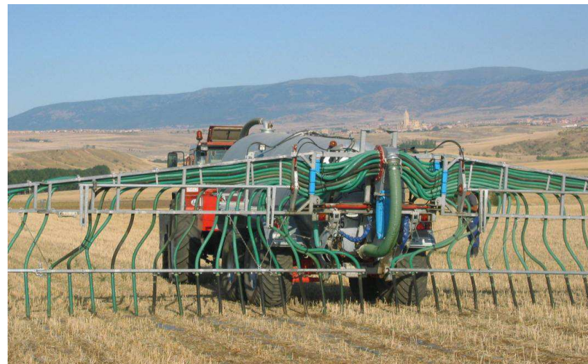
Figura 11. Esempio di spandiliquame a banda con distributore rotativo per migliorare la distribuzione laterale (trailing hose)*
