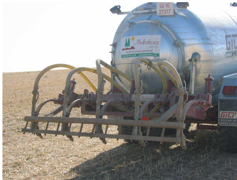
Figura 15. Esempio di iniettore a solchi aperti*
