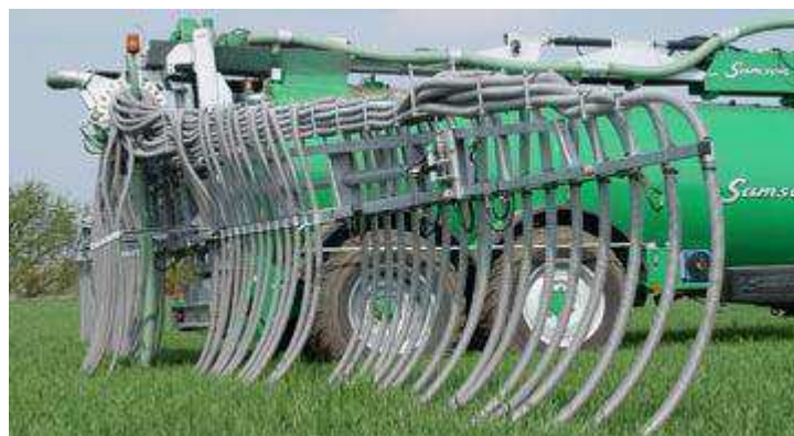
Figura 12. Esempio di trailing hose montato su una sbarra*
